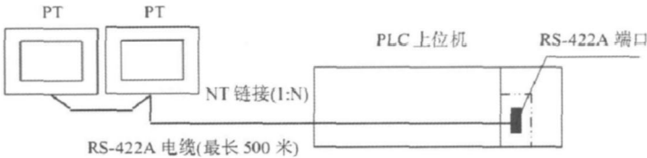
图9 PLC 和 PT 链接方式结构图
